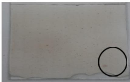
**Figura 2. Revelação do padrão de 11-nor-9-carboxi- $\Delta^9$ -THC (THC-COOH) com Fast Blue BB. (1- 0,2 µg/ml, 2- 1 µg/ml, 3- 10 µg/ml)**
